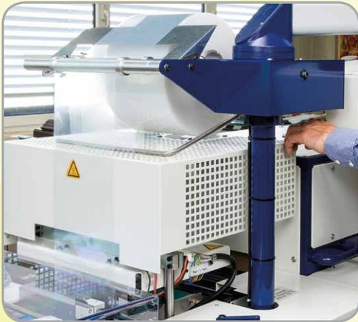
Die Abdeckung der Schweißeinheit lässt sich bei der neuen Geräteversion der NGZ 8010 bequem anheben und zur Seite schwenken.
